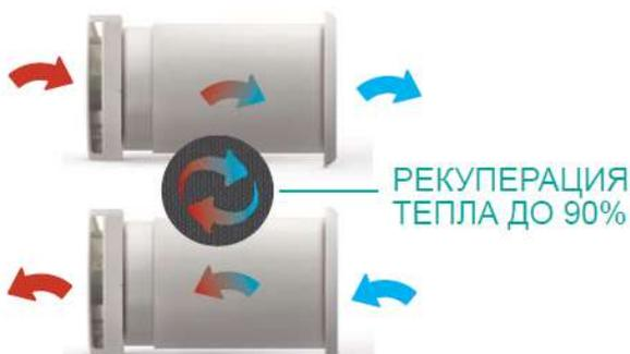
Приток и вытяжка воздуха происходит благодаря реверсивному двигателю. Прибор поочередно работает на приток и вытяжку, меняя направление движения воздуха согласно заданной программе или заданию от датчика температуры, от 10 до 100 секунд.
